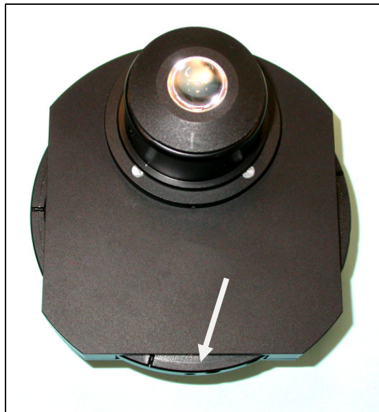
Abb. 16: Kombikondensator mit Ringblenden-Revolverscheibe (Pfeil).
