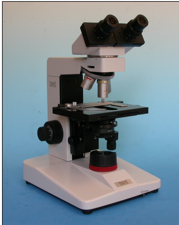
Abb. 15: Das H 600 BS für die Belebtschlamm-Untersuchung.
