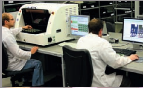
Bild 2: Per AOI wird sichergestellt, dass die Bauteile vollständig und am richtigen Ort platziert werden.
