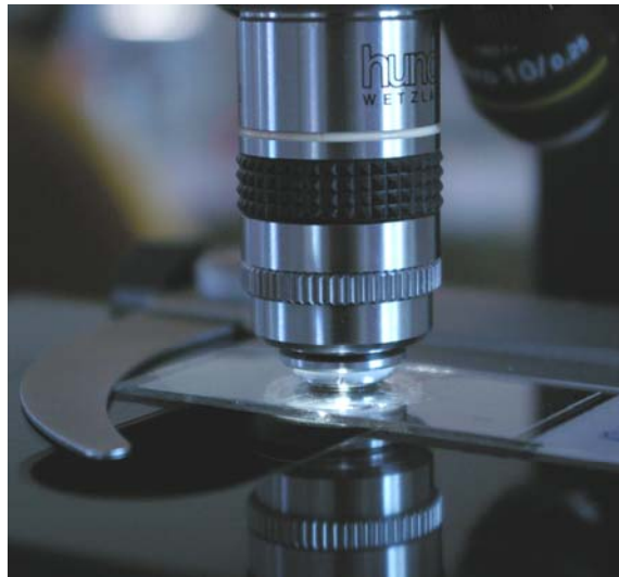
Abb. 4: Objektiv Plan 100/1,25 – 0,60 Oel mit Irisblende.
